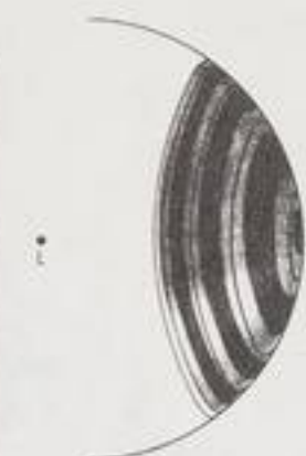
550. Fresnelsche Zonen auf einer Kugel um eine Lichtquelle L. Die Abstände vom Beobachter B zu den Zonen werden von Zone zu Zone um \lambda/2 größer. Die schattierten Ringe bezeichnen jeweils Gebiete benachbarter Zonen, aus denen sich das Licht durch Interferenz weghebt.
