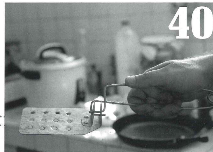
(40) Écumoire mécanique Écumoire "améliorée" pour retirer les fritures de l'huile. Système à ressort permettant d'une simple pression du manche de faire tourner l'écumoire de 90° pour la vider de son contenu. Commercialisé à La Havane, inventé et fabriqué par des prisonniers, 1999.
