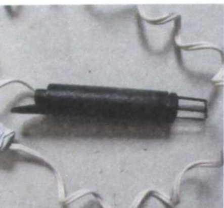
Allume-gaz qui fonctionne sur le principe du court-circuit électrique.
