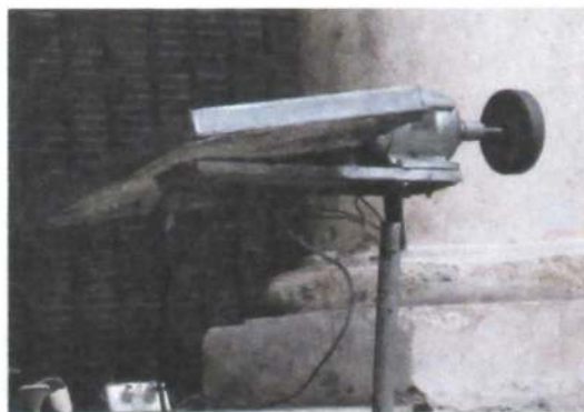
Moteurs de machines à laver Aurika utilisés comme outil par des cordonniers.
