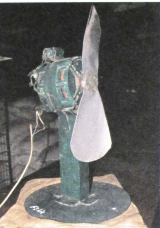
Moteurs de machine à laver Aurika insérés dans des ventilateurs.
