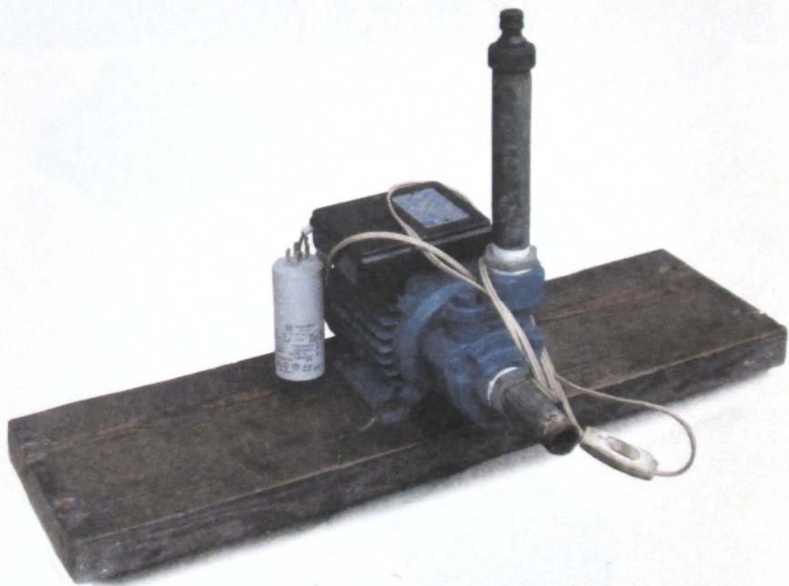
Pompe portative pour puiser l'eau.
