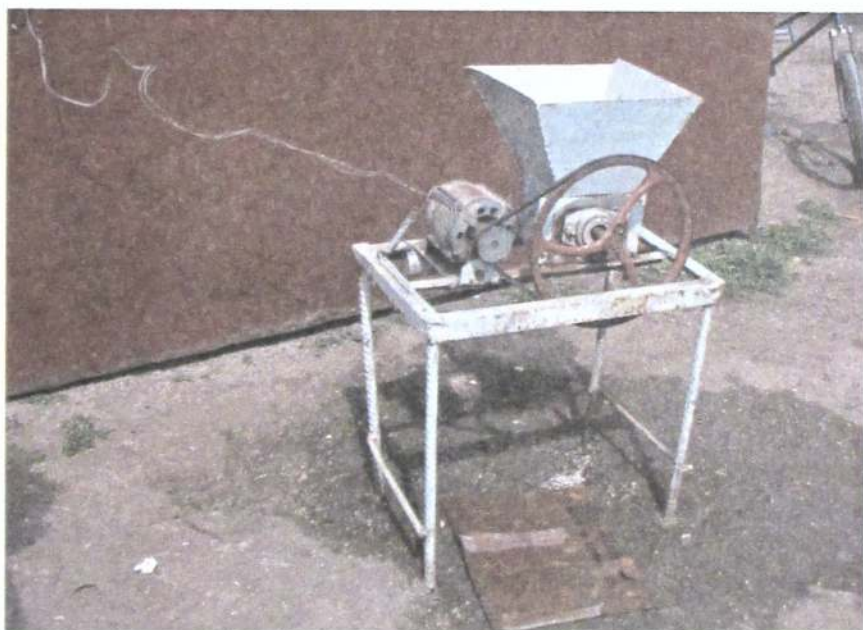
Moteur de machine à laver Aurika utilisé pour couper les noix de coco.
