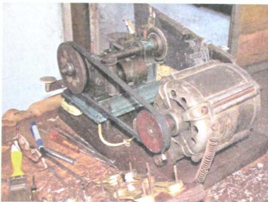
Moteur de machine à laver Aurika utilisé comme outil pour dupliquer des clés.
