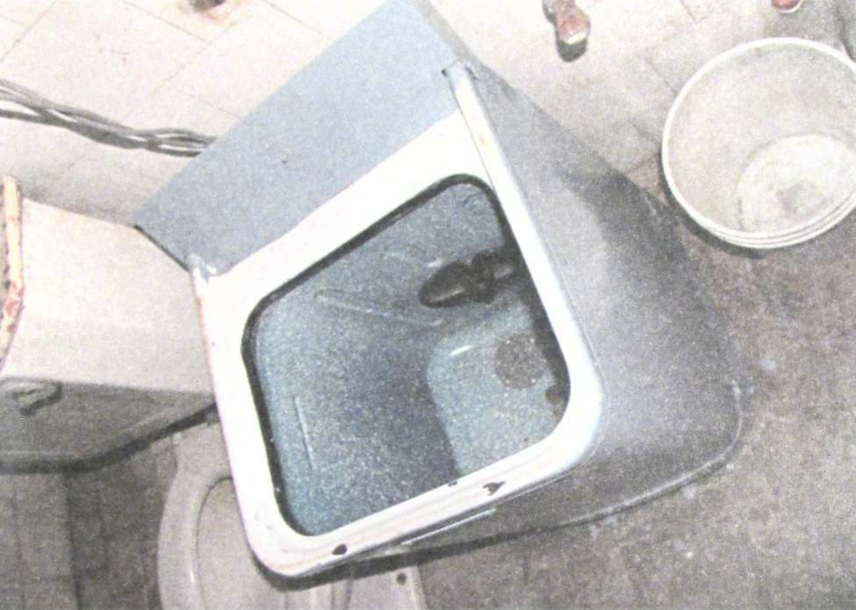
Machine à laver Aurika dont la partie séchage a été retirée.
