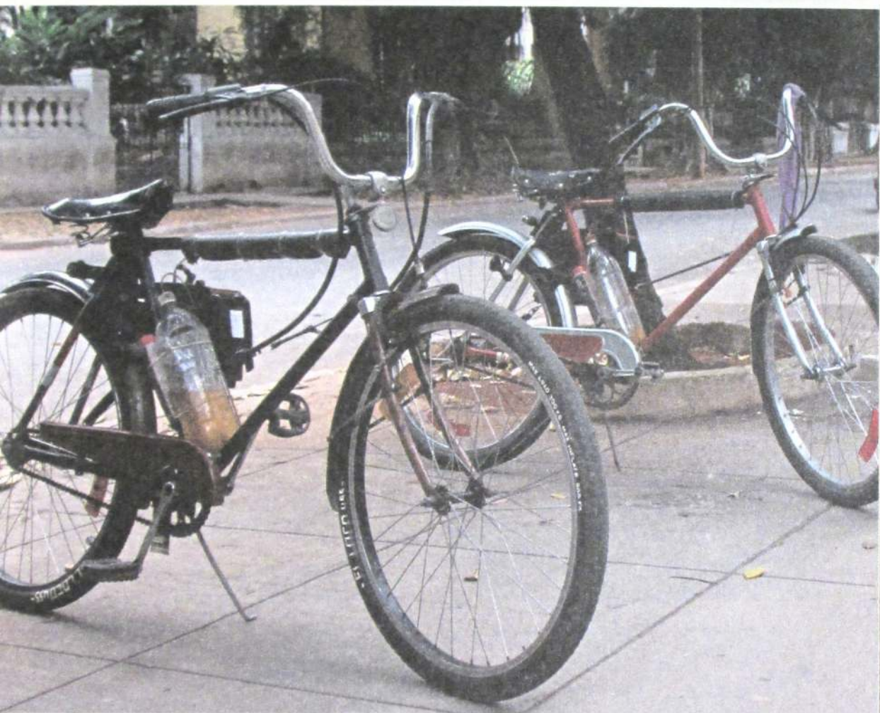
Rikimbilis équipés de moteurs d'origines diverses : pompe à eau, tronçonneuse, machine de fumigation, tourelle de tank, etc. (pages 60-66).
