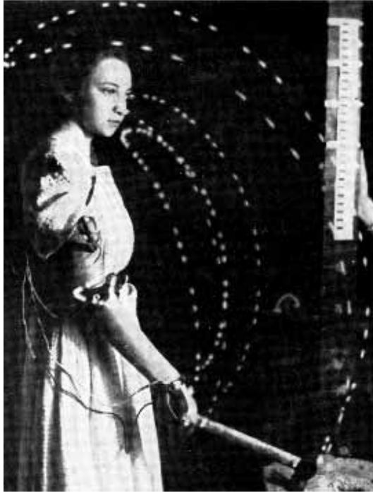
Fig. 87 y 88. Golpe y presión: Perforación del método cronociclográfico en el Instituto del Trabajo de Gastev. En el ejemplo, una obrera con prótesis de brazo. El martillo está provisto de dos puntos de luz fosforescente, de tal forma que los movimientos de las curvas punteadas se pueden registrar fotográficamente. Sobre el margen derecho de la imagen es sostenida una escala como unidad de registro. Diagrama de los movimientos de un trabajador al cincelar con un martillo.
