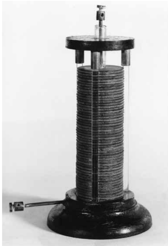
Fig. 62. La columna de carga (el acumulador) de Johann Wilhelm Ritter es reconocida como el primer aparato para el almacenamiento de energía con base electroquímica. (Colección de objetos del Museo Alemán de Múnich).
